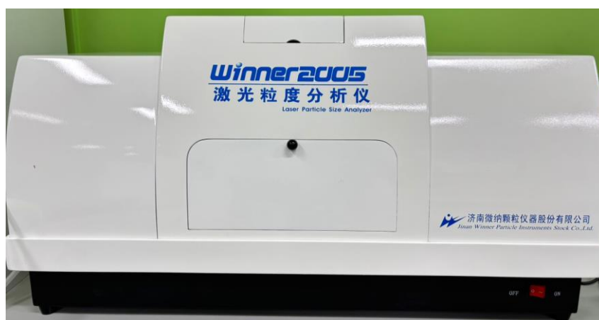
20 сурет - Winner 2005A лазерлік бөлшек өлшемін талдау құрылғысы.
